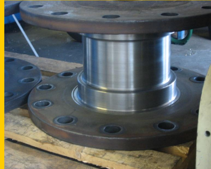
fertig bearbeitete Lager- und Dichtsitze
